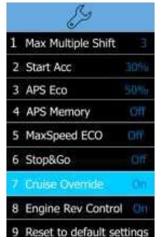
U traktorů vybavených volitelným joystickem Advance (AO002) bude možné měnit rychlosť jízdy i při aktivní funkci. Pohybem kolečka na boku joysticku bude možné upravit rychlosť tempomatu.
