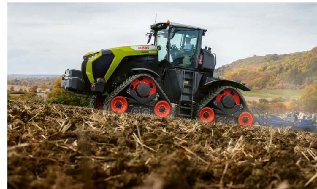
◀ Konceptce odpružení - počínaje tlumením pásového podvozku, přes čtyřbodové odpružení kabiny, až po odpružené prémiové sedadlo – zajišťuje v traktoru XERION obzvláště vysoký komfort jízdy.
